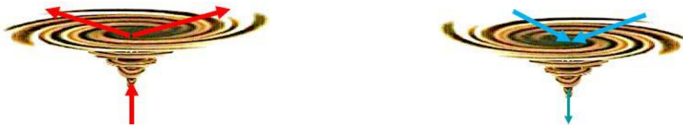
FIGURA 1 il vortice si curva nel piano, espansione(rosso) o contrazione (blu) ad eccezione del nucleo centrale dove si rileva fuori dal piano o verso l'alto (polarità p = + ) o verso il basso (polarità p = - )
